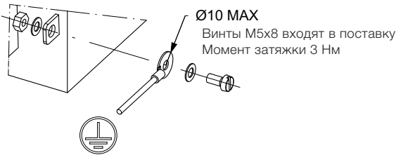
Устройство заземления FA2 - FA4
